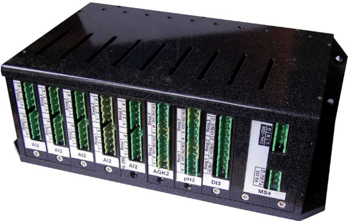
Рисунок А.3 - Блок модулей ввода-вывода БМ-8
